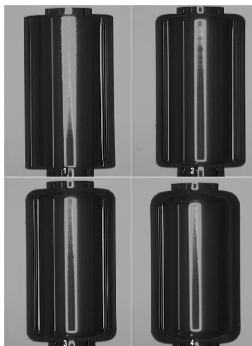
Fig. 3. Mandrels of edge radius: (1) 0.15 mm, (2) 0.40 mm, (3) 0.60 mm, (4) 0.80 mm.
