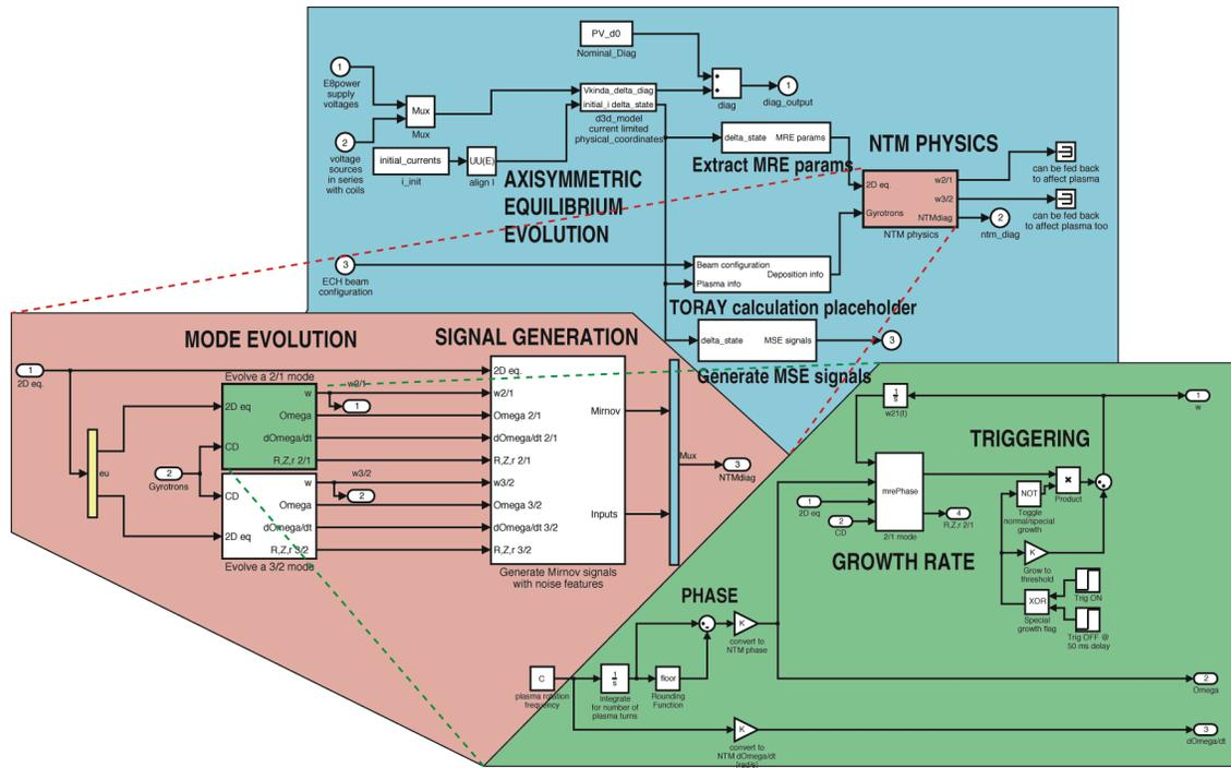
Fig. 2. Structure of Simulink<sup>®</sup> NTM simulation.
