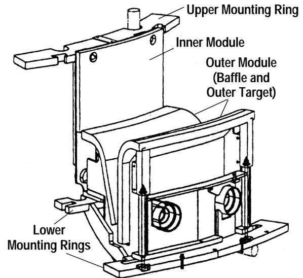
Fig. 1. TPX divertor module concept.
