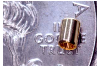
Fig. 3–27. Copper hohlraum mandrel.
